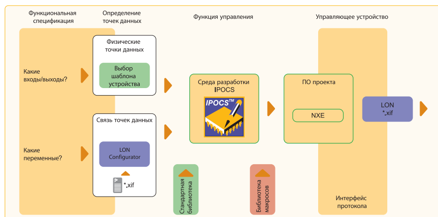
IPOCS: пример программирования контроллеров OMDX, MIOX, MIOWX, LCS, LCU
