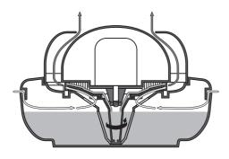
Defensor 505 работает по принципу распыления. еода из резервуара поступает во всасывающий патрубок. Вращающийся диск продвигает воду по направлению к кольцу распылителя, где вода превращается в аэрозоль.
