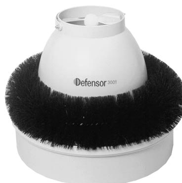
Щетка фильтра прикреплена к алюминиевому кольцу, которое может быть установлено в резервуаре для воды в системе (см. рисунок выше). Электрический шнур установки должен быть протянут через кольцо. Воздух, необходимый для установки, вынужден пройти через щетку фильтра, что задерживает волокнистую пыль. Это значительно предотвращает скопление пыли в установке и, соответственно, снижает время техобслуживания.
