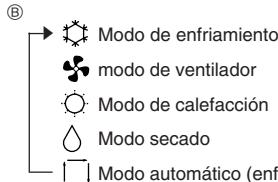
\*1. Cuando seleccione el modo de ventilador mediante el interruptor dip interno (SW1-1) ON, el visor mostrará en lugar de □.
