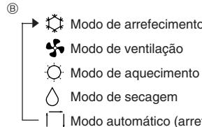
\*1. Quando selecciona o modo de Ventilação utilizando o interruptor dip interior (SW1-1) ON, o mostrador indica em vez de □.
