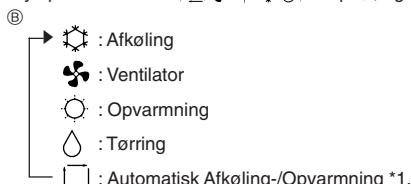
\*1. Når De vælger ventilatortilstand via den indendørs DIP-kontakt (SW1-1) ON, viser displayet i stedet for □.
