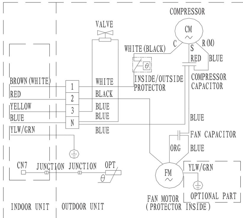
Обозначения блоков: INDOOR UNIT – внутренний блок, OUTDOOR UNIT – наружный блок.
